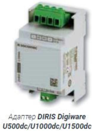
Модуль **DIRIS Digiware U-3xdc** измеряет напряжение постоянного тока во всей системе. Он измеряет до 180В постоянного тока с прямым подключением и поэтому совместим с типичными номинальными напряжениями (24 В постоянного тока, 48В постоянного тока ...). Адаптеры напряжения обеспечивают совместимость системы со всеми уровнями.
